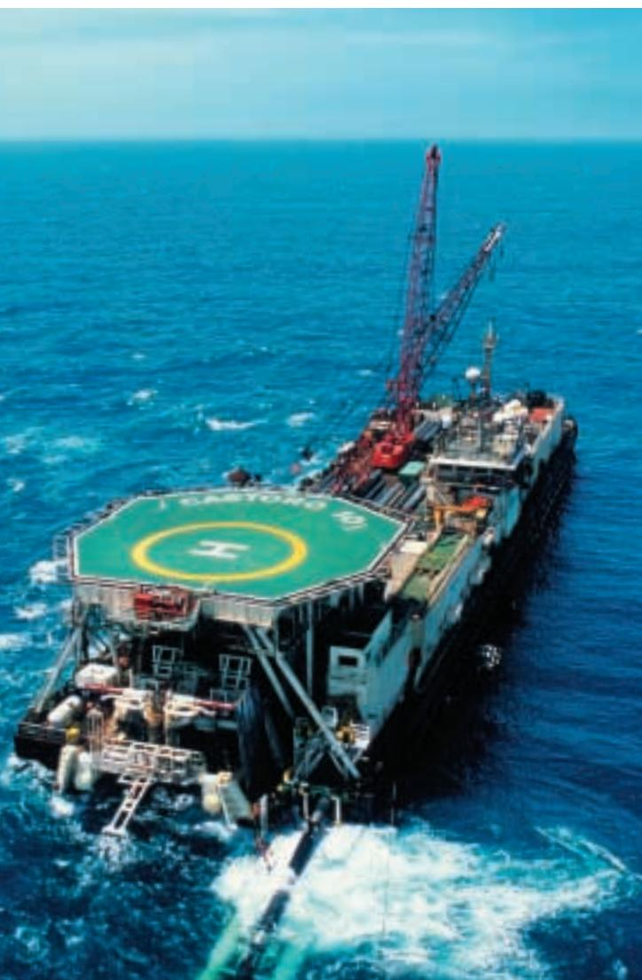
這艘鋪管船正在為香港電燈鋪設連接深圳與南丫島的天然氣管道，以便日後為渦輪燃氣機組供氣。
