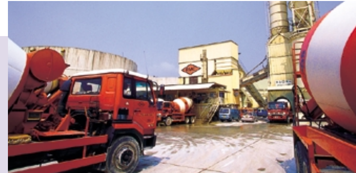
此泥漿攪拌廠每小時的產量可達三百立方米。
